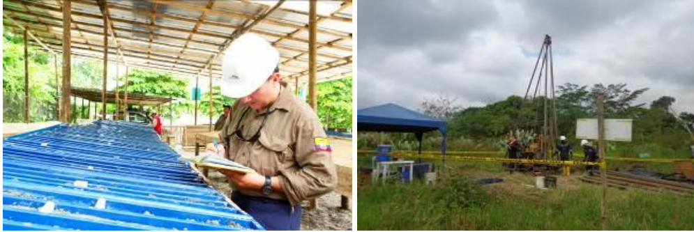
Fotografías Nro. 6 y 7. Logueo de testigos y plataforma de perforación
