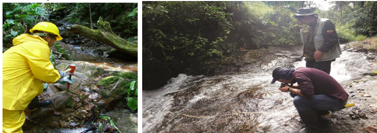
Fotografías Nro. 16 y 17. Toma de muestras de rocas en afloramientos y sedimentos fluviales
