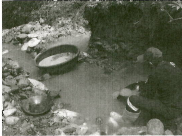
Lavado del concentrado de arena de la muestra CH11
